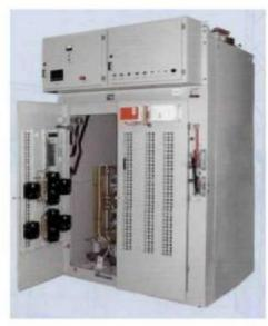
Устройство УППВЭ обеспечивает плавный пуск высоковольтных синхронных и асинхронных двигателей, насосов, компрессоров, вентиляторов, воздуходувок и др. Плавный пуск достигается за счет формирования заданного темпа нарастания напряжения на двигателе от нуля до номинального значения.
